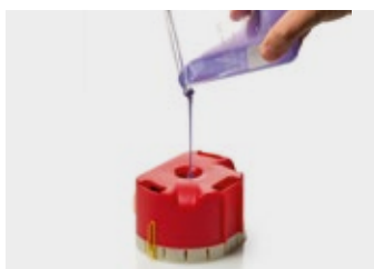
5. Pour Elite Double 16 into the flask
